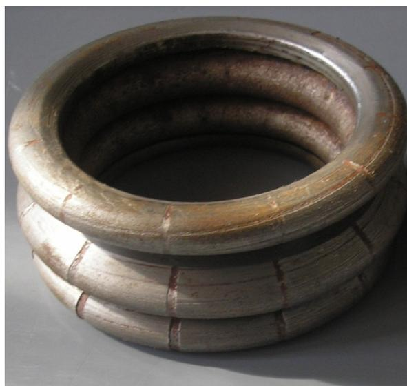
Рис. 3. Пластически деформируемый элемент после срабатывания
